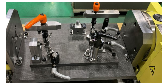
CFRP治具の試作例（自動車部品用）
